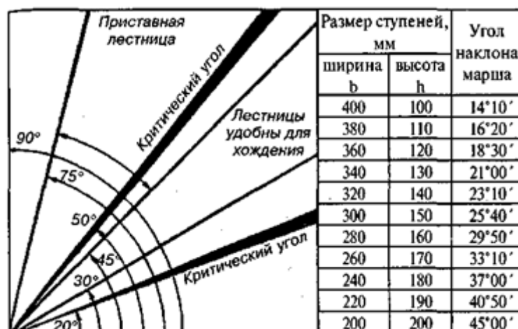
Рис. 8. Диаграмма соотношения между размерами ступеней и углом наклона марша
